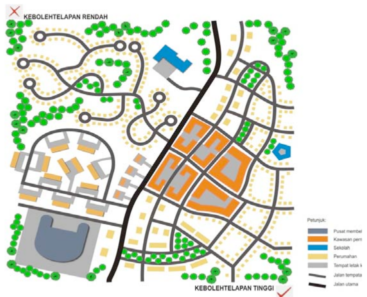
Rajah 9 : Perbandingan corak jalan dengan kebolehtelapan yang tinggi dan rendah.
