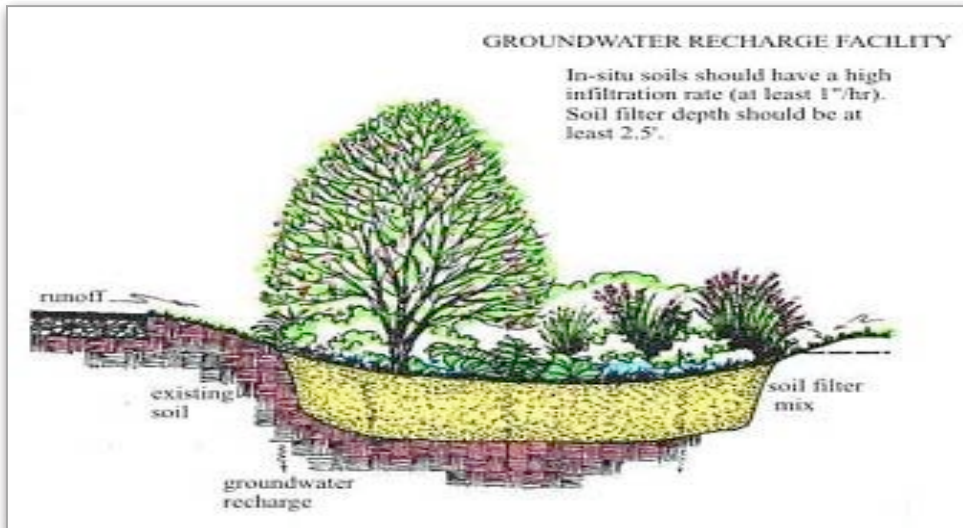
Rajah 35 : Konsep bio-retention (sebagai penapis dan penyerap air larian permukaan) di kawasan pembangunan
